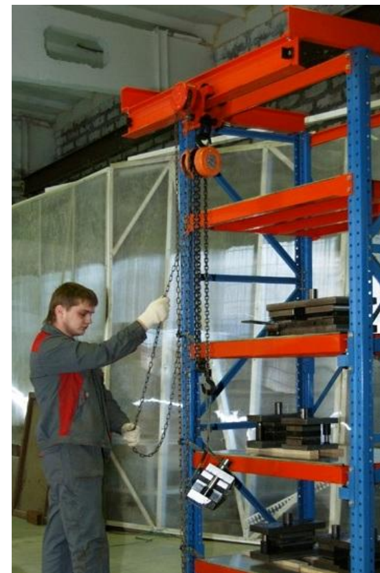
Стеллаж Slide со встроенной талью. Высота 2700 мм.
