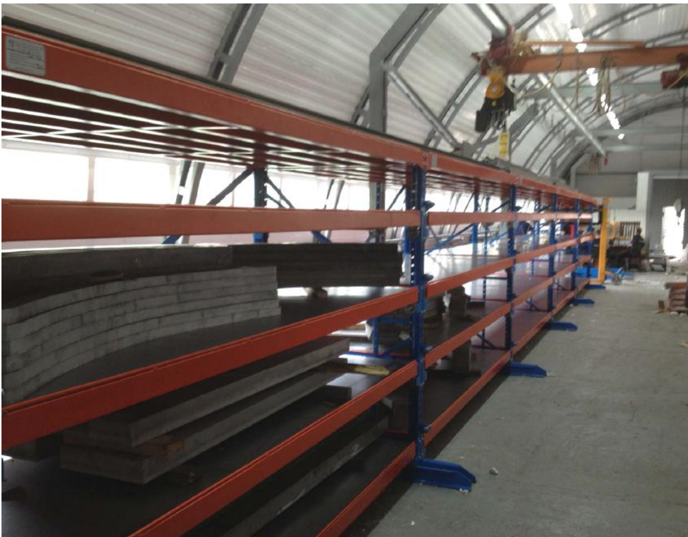
Фото 11. Стеллажи Slide собраны в линейку. Конструкция без тали. Подъемный механизм – потолочная кран-балка.
