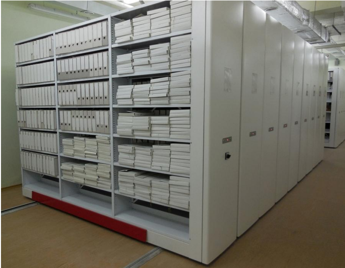
Фото 4. Стеллажи с электроприводом. Управление с панели кнопок, с сенсорного экрана на стеллаже, с планшетного компьютера. Серия «Актив».
