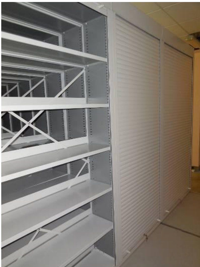
Фото 5. Крайние секции передвижного стеллажа закрыты жалюзи.
